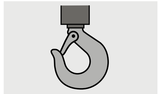
Bild 5: Lasthaken mit Hakensicherung.
